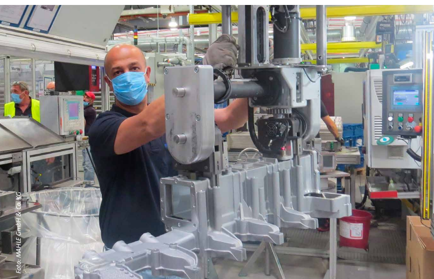
Mit dem Lastenmanipulator kann Produktionsmitarbeiter Elmi Zumberi die schweren Gussteile genau an die benötigte Position in der Fertigung bewegen.
