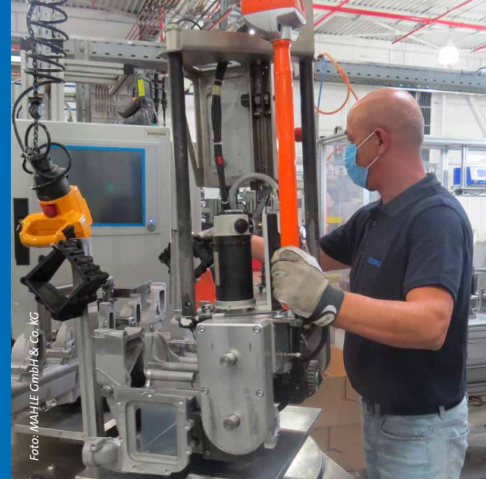
Erleichtertes Arbeiten bei MAHLE in Mühlacker: dank des neuen Lastenmanipulators
